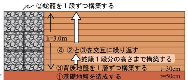
図 5 模型地盤の施工手順
