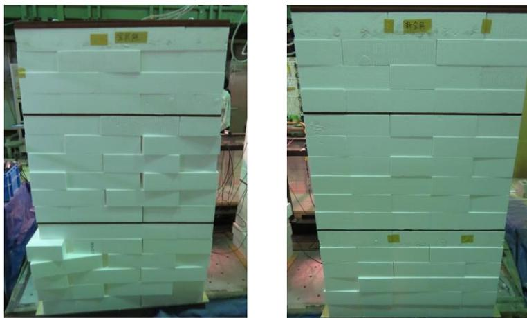
写真-2 実験結果の例(ケース1, 左:金具なし, 右:新金具15個)
