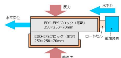
図-2 試験装置の概略
